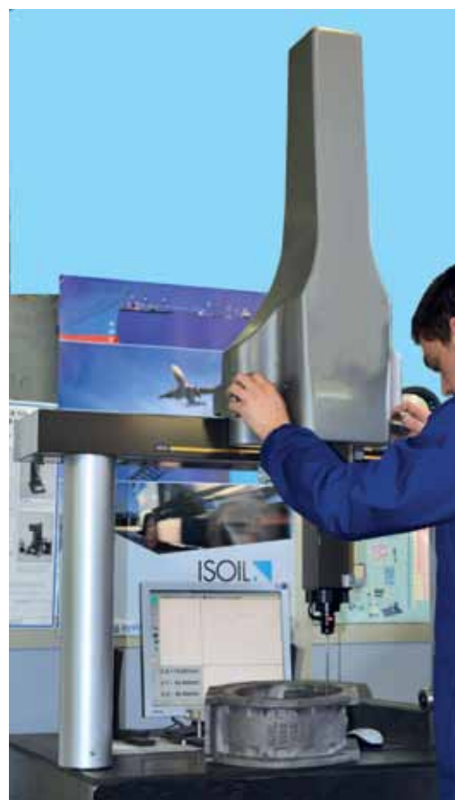
Controllo tridimensionale di alcuni componenti mediante macchina di misura 3D
